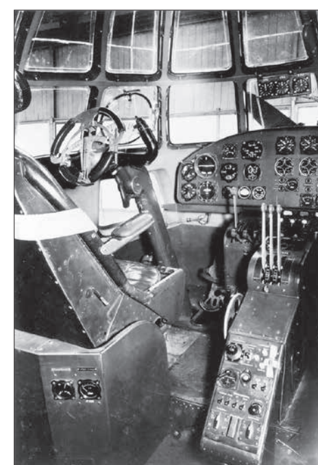
An der Ju 252 V1 war 1942 erstmals der neue Einheitsführerstand eingebaut. Auf der Steuersäule sind die Winkelmesser für die Querruder angebaut.
