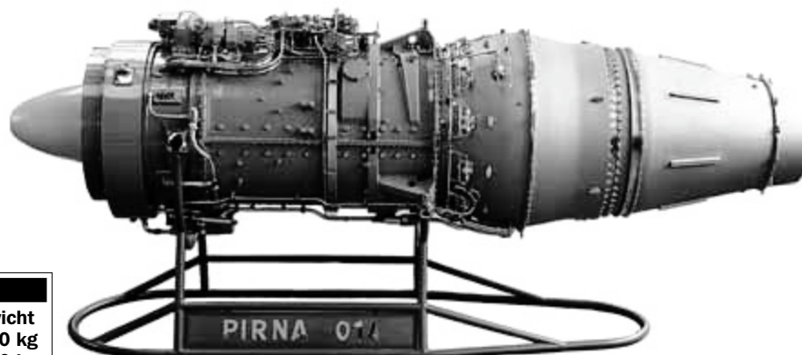
Der einfache Aufbau und der geringe spezifische Kraftstoffverbrauch waren die Hauptmerkmale des TL 014. Gegen Ende der DDR-Luftfahrtindustrie wurden einige Flugtriebwerke zu stationären Stromerzeugern und zu Schiffsturbinen umgebaut.
