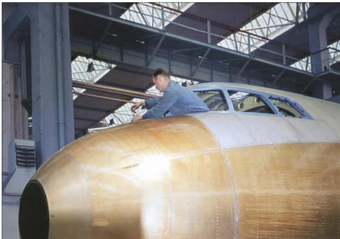
**Rumpf der Nullserienmaschine 010 im Juni 1960. Ab der 010 wurde der Schutzlack so beherrscht, dass die Präzisionsnietung gleich durch den Schutzlack erfolgen konnte. Das hatte den Vorteil, dass sich zwischen Niet und Blech fest eingepresster Schutzlack befand, der die interkristalline Korrosion verhinderte. Alle blau gestrichenen Teile (hier Verglasungsgerüst) sind Teile aus Stahl. Am Flugzeug sind das meist Beschläge, Einfassungen und Verstärkungen.**
