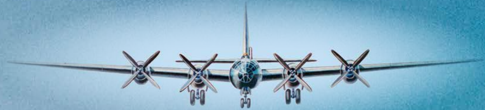
Die viermotorige Tupolew Tu-4 war eine vom Konstruktionskollektiv Wladimir Michailowitsch Mjassischtschew auf sowjetische (metrische) Normen umkonstruierte Boeing B-29.
