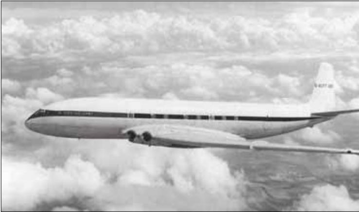
Die G-ALYT war die vierte Serienmaschine aus der Comet-1-Produktion. Sie bekam die Axialturbine Avon RA. 9 Mark 501 anstelle der Ghost-Triebwerke eingebaut und avancierte so zur ersten Comet 2 (Erstflug: 16. Februar 1952).
