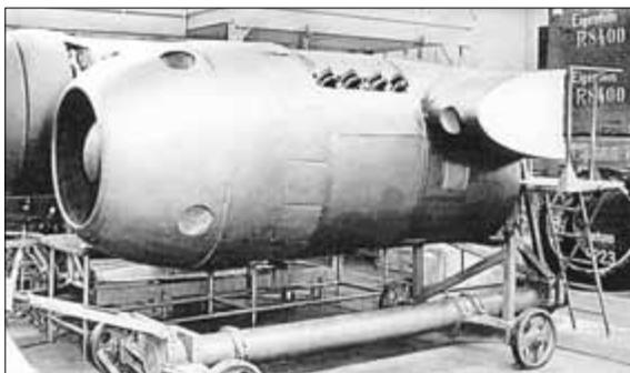
**Die Doppelhaube sollte eine aerodynamisch günstige Formgebung mit bester Kühlung verbinden. Das separat vorgefertigte Einheitstriebwerk brauchte nur noch an den Flügel angeschraubt und die Schnelltrennstellen der Kraftstoff-, Hydraulik- und Elektroleitungen verbunden werden.**
