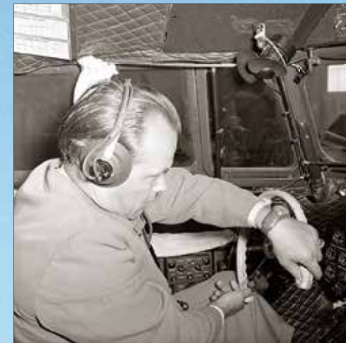
Chefpilot Karl Treuter demonstriert, wie ungewöhnlich weit das Querruder gedreht werden kann.
